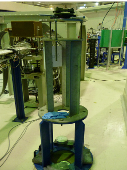
รูปที่ 4 แสดงตำแหน่งอ้างอิงสำหรับปรับตำแหน่งของแม่เหล็ก
